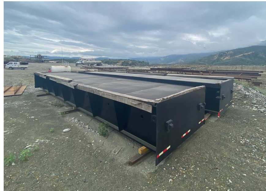
Compuerta Ataguía - Obra
