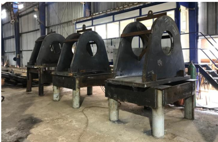
Compuerta Radial Soportes de muñones
