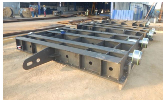
Compuertas del Desvío
